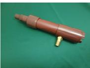
充填機ノズル内の洗浄に使用します。
