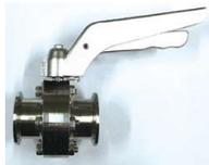
溝のついたフェルールにパッキンを取り付け、クランプバンドを締めて接続する継手です。ボディー内の弁は液体の流れを妨げない、なだらかな構造で、汚れを溜めにくく洗浄性に優れています。他方式のバルブに比べて省スペースに設置が可能です。
