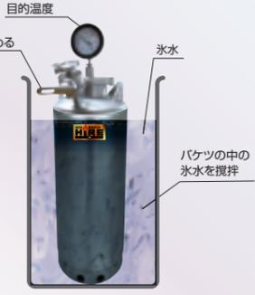
④ ハルブは閉めたままで氷水に投入し、酒温が目的冷却温度に達したら完了。
